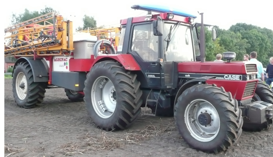
Figuur 3: Yara N-sensor gekoppeld aan veldspuit om variabel aardappelloof te doden.
